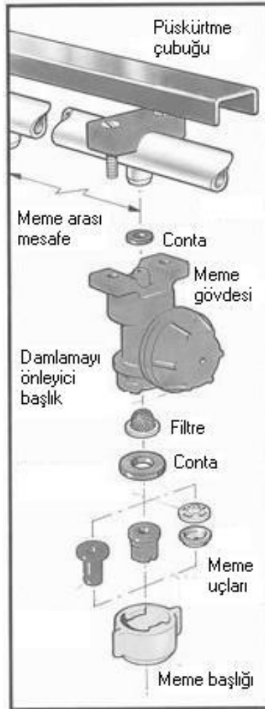
Şekil 5.10 Meme parçacıkları ve püskürtme çubuğuna bağlantı elemanları (Anonim, 1994)
